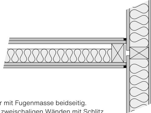
Widerlager mit Fugenmasse beidseitig. Tafeln auf zweischaligen Wänden mit Schlitz.
