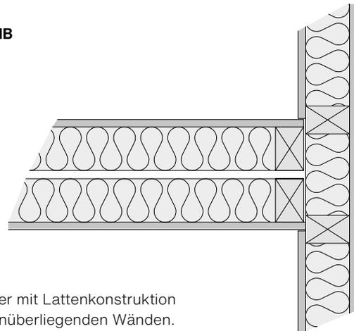
Widerlager mit Lattenkonstruktion auf gegenüberliegenden Wänden.
