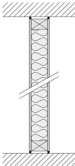
Widerlager an Boden, Wand und Decke mit Fugenmasse beidseitig.
