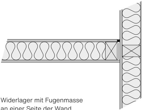
Widerlager mit Fugenmasse an einer Seite der Wand.
