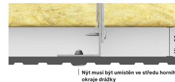
Obr. 2. Horizontální řez kotevním prvkem ve středu desky
