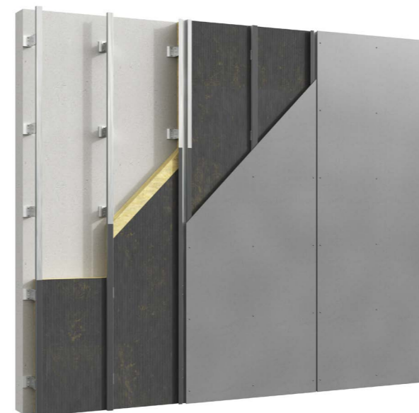
Podkladní konstrukce s použitím ocelových profilů.
