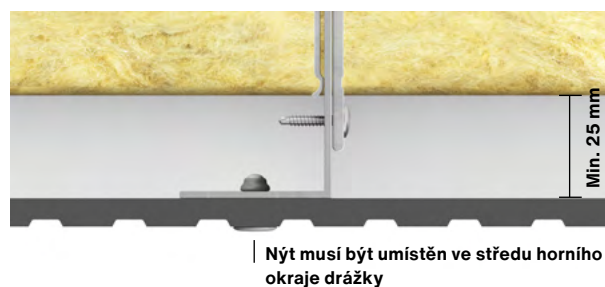
Obr. 2. Horizontální řez kotevním prvkem ve středu desky
