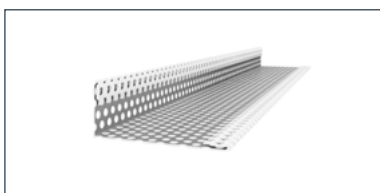
7. Swisspearl ventilační profil, vyrobeno z perforovaného ocelového plechu tl. 0.6 mm, délka 3000 mm. Minimální šířka větrané mezery v případě použití mřížky je 40 mm
