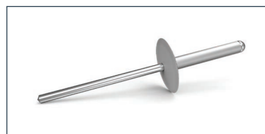
Blindklinknagels voor aluminium Swisspearl RIV-A 5,0x18 mm met EPDM opvulring Alu nagelhuls en RVS trekpen. Blank of in de kleur van de gevelpanelen
