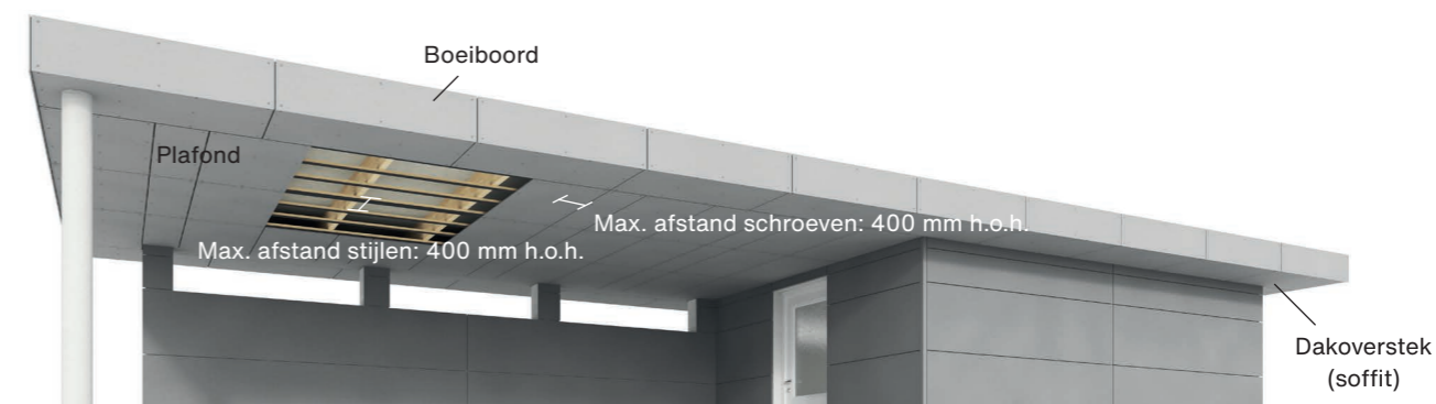
Tussenafstanden van schroeven en regelwerk
