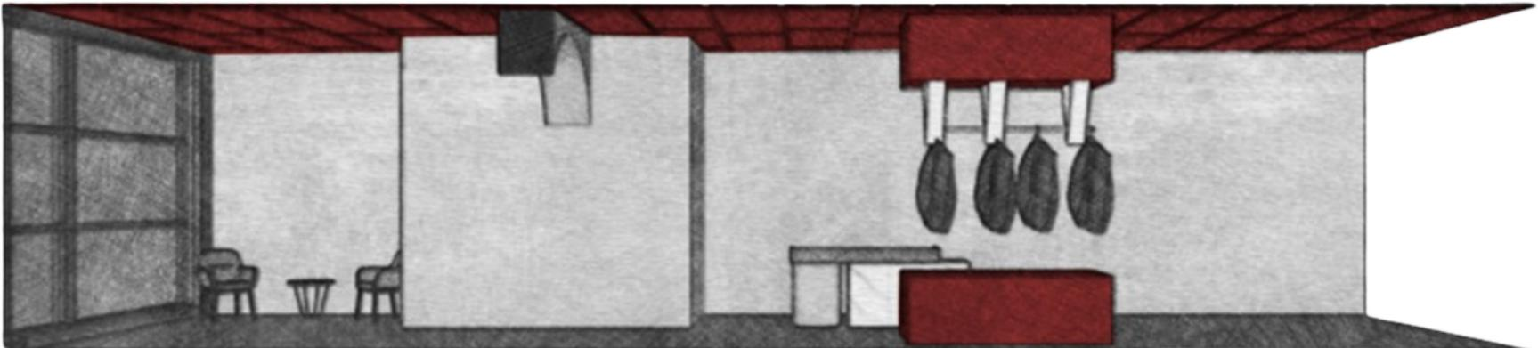
Die Decke wird mit Carat Platten verkleidet, die Platten sind 176cm lang, 73cm Breit und 1,2cm Dick. 3 Platten sind der Breite nach verbaut, denn Abschluss bildete eine 42cm lange Platte. Es werden insgesamt 20 Reihen gebaut.
