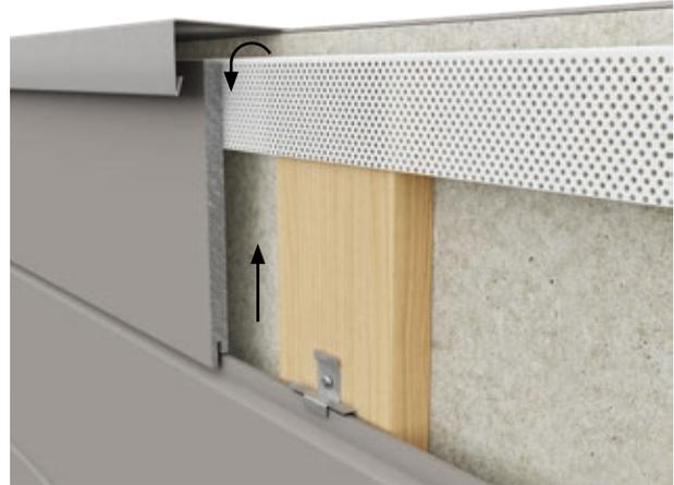
Die Lüftungsöffnung muss ebenfalls am oberen Ende der Fassade eingehalten werden. Genau wie am Sockel muss ein Lüftungsspalt von mindestens 10 mm oder  $50 \text{ cm}^2$  pro laufenden Meter gewährleistet sein.
