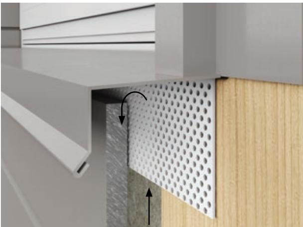
Unter den Fensterbänken ist ebenso ein Mindestabstand von 10 mm oder  $50 \text{ cm}^2$  pro laufendem Meter einzuhalten. Der Lüftungsspalt wird zwischen der oberen Kante der Fassadenpaneele und der Unterkante der Fensterbank gebildet. Es wird empfohlen, die Tropfkante/Wassernase mindestens 30 mm vor die Fassadenfläche zu setzen. Dieser Aufbau stellt sicher, dass abfließendes Wasser vom Fenster nicht in die Unterkonstruktion/hinter die Bekleidung läuft.
