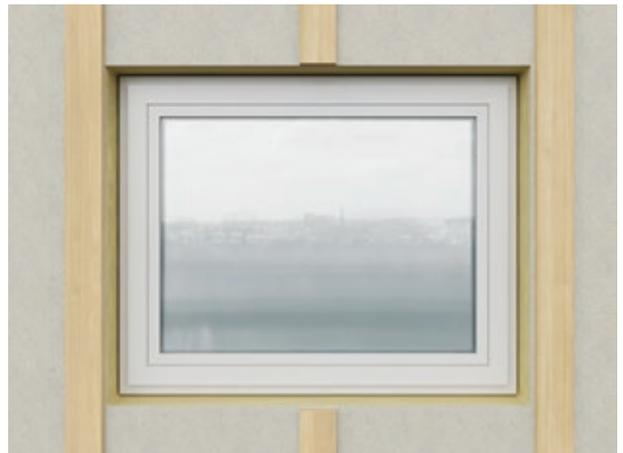
Swisspearl Lüftungsprofile ober- und unterhalb der Öffnungen anbringen.
