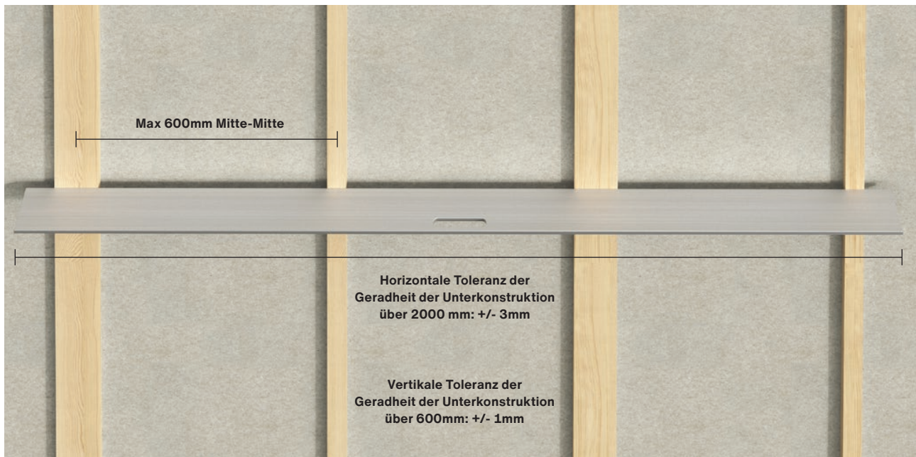
Geradheit der Unterkonstruktion
