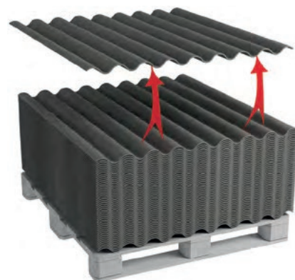
Ikvienu loksni ņemot no paletes, vajag to pacelt uz augšu. Nekādā gadījumā nedrīkst to stumt vai vilkt no paletes. Tas var sabojāt zemāk esošo lokšņu krāsas slāni.
