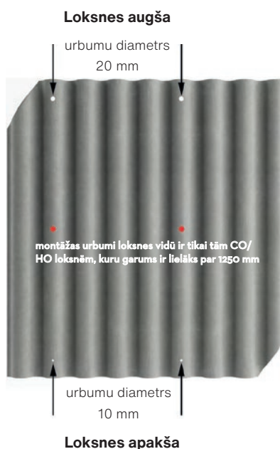
22. att. Lokсне Swisspearl W130-9C O/HO – nogriezti stūri un montāžas urbumi. Loksnēm Swisspearl W130- 9 CO/HO montāžas urbumi izurbti 2. un 5. viļņa virsotnē.
