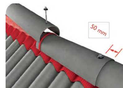
35. att. Pusapaļa kores elementa montāža.
