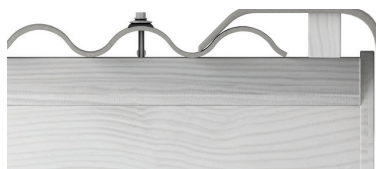
40. att. Vējmalas ar liektu malu montāža.
