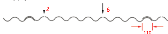
16. att. Montāžas urbumu iestrādes vietas, ja jumta segumu sāk uzklāt no kreisās jumta slīpes puses – loksnes Swisspearl W130-9.
