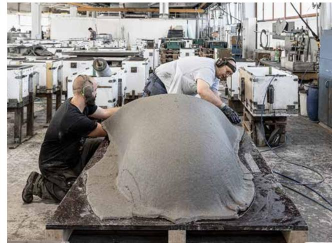
La vasque est modelée à la main et réalisée en une seule opération. Pour cela, un lé en fibres-ciment de 2,5 fois 1,2 mètre est enroulé sur un moule.
