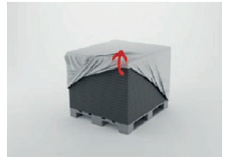
Pärast ehitusplatsile tarnimist tuleb kaitsev plastik pakend eemaldada.
