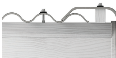
Joonis 40. Painutatud servaga tuulelaua paigaldamine.
