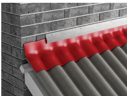
Joonis 44. Katuseviilu ja hoone seinä ühenduskoha ehitamine.
