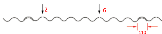
Joonis 16. Kinnituskude puurimise kohad juhul, kui katust hakatakse katma katuseviilu vasakult poolt: plaadid W130-9.
