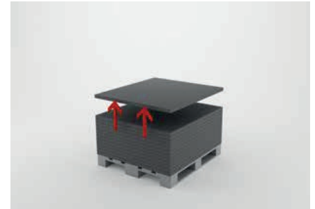
Iga plaati aluselt võttes tuleb see üles tõsta. Mingil juhul ei ole lubatud plaate vinnast maha tõmmata ega lükata. Plaatide tõmbamisel rikume ja kahjustame alumiste plaatide värvitud pinda.
