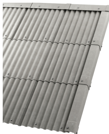
Joonis 38. Tuulelaudade paigaldamisviis.
