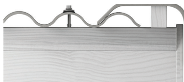
40 pav. Vėjalentės su lenkta briauna montavimas.
