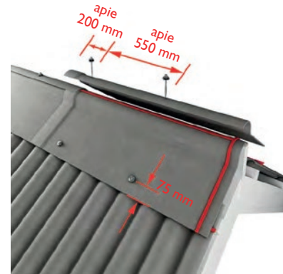
36 pav. Reguliuojamo kraigo elemento montavimas.
