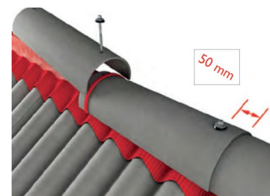
35. att. Pusapaļa kores elementa montāža.
