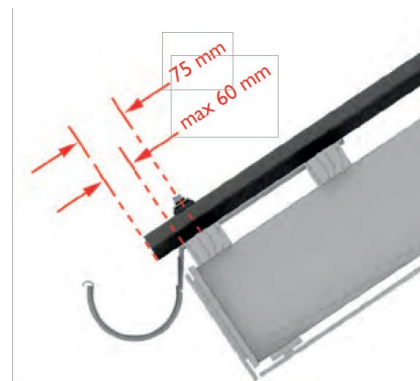
20. att. Attālumam no loksnes gala līdz stiprinājuma punktam ir jābūt ne mazākam par 75 mm.
