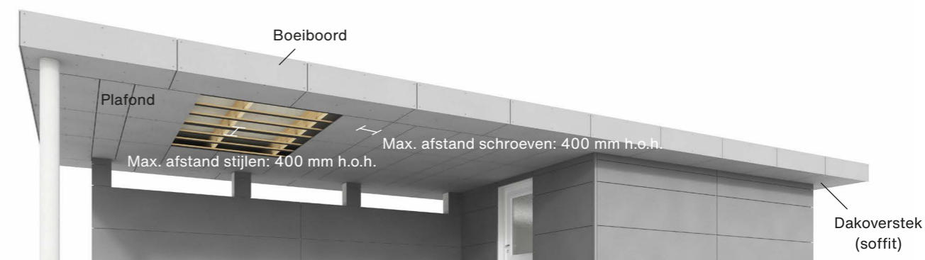
Tussenafstanden van schroeven en regelwerk
