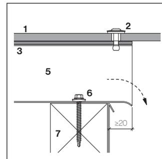
Plier (goutte pendante) le profilé trapézoïdal double pour qu'il déverse dans le couloir d'évacuation de l'eau.
