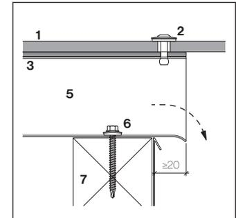
Plier (goutte pendante) le profilé trapézoïdal double pour qu'il déverse dans le couloir d'évacuation de l'eau.
