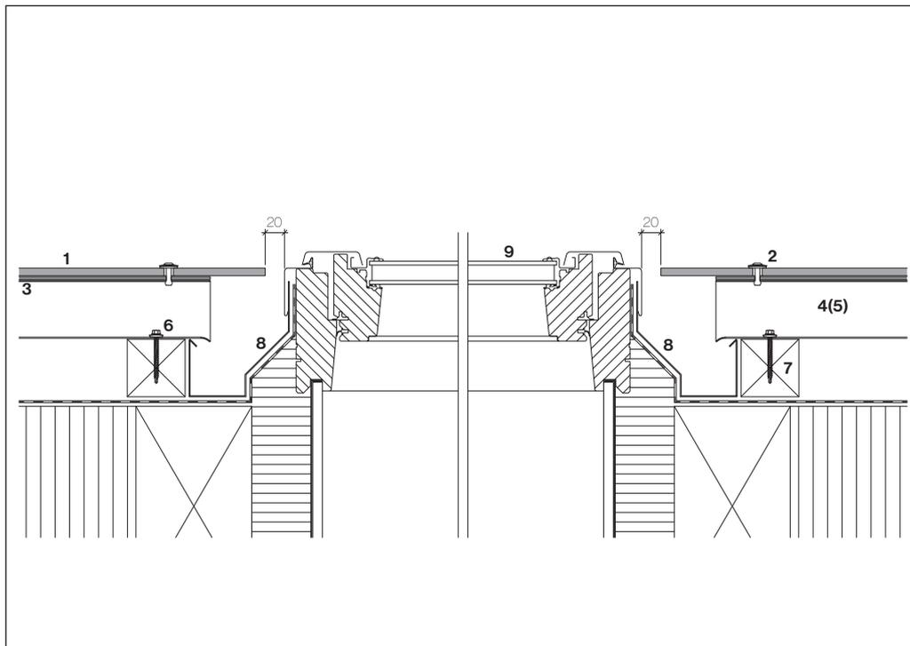
L'évacuation des eaux se fait dans l'épaisseur des contre-lattes avec un système de couloir (fourni par la DT) jusque dans le chéneau. Respecter la pente minimale pour les fenêtres de toiture, selon indications du fabricant.
