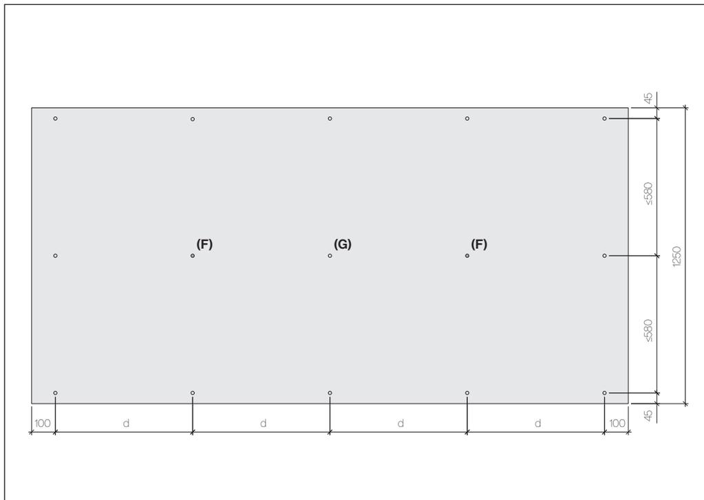
2 points fixes (F) par module, les autres points de fixation sont des points de dilatation (G)
