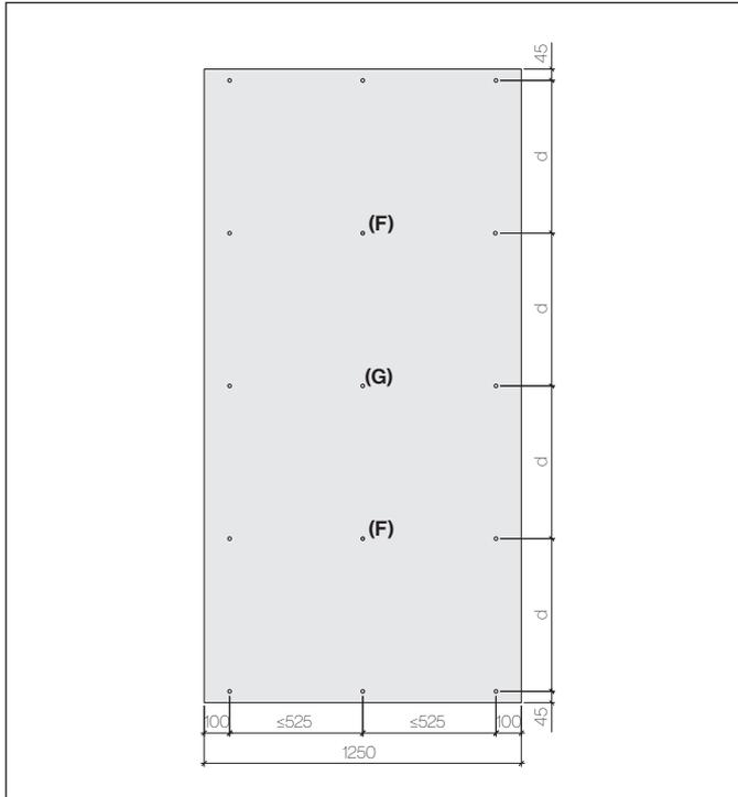
2 points fixes (F) par module, les autres points de fixation sont des points de dilatation (G)
