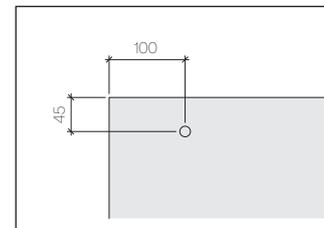
Les distances entre points de fixation et bord de plaque doivent être strictement respectées, tant pour l'alignement horizontal que vertical.
