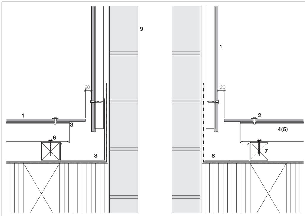
L'évacuation des eaux se fait dans l'épaisseur des contre-lattes avec un système de couloir (fourni par la DT) jusque dans le chéneau.
