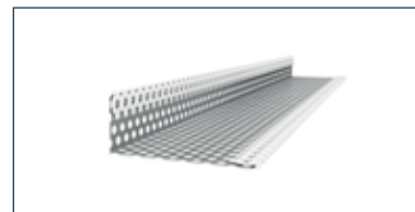
3. Vėdinimo profilis „Swisspearl“ 0,6 mm perforuotas metalas. Ilgis 3000 mm
