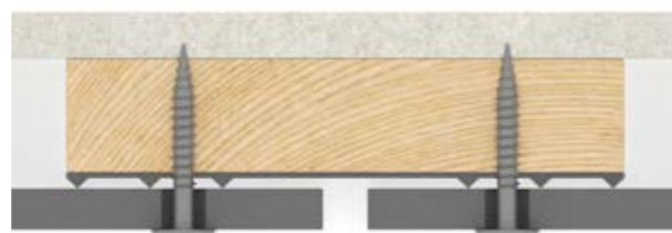
Sintef prosjekter EPDM min. 20mm bredere enn lekt.
