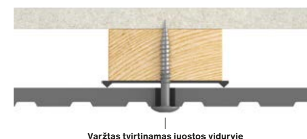
2 pav. „Swisspearl Patina Inline“ montavimas prie vidurinio karkaso elemento.
