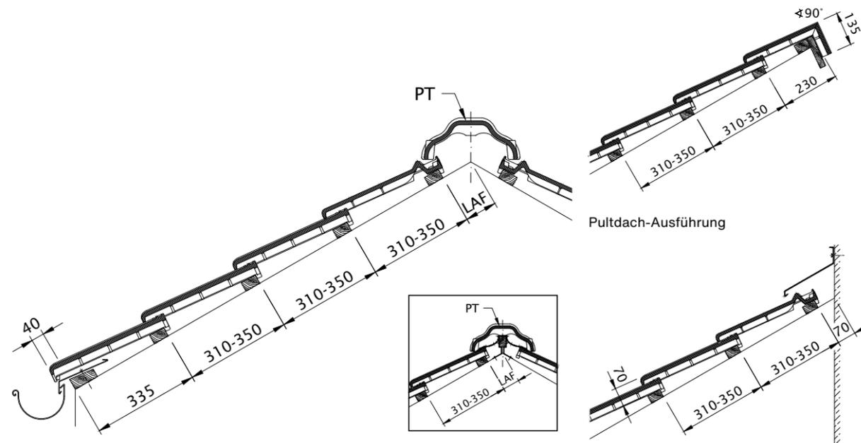
Dachquerschnitt Entlüftung über FALZ. Firstziegel trocken verlegt. LQ bis ca. 230 cm<sup>2</sup>/lfm First. Traufplattenabstand variabel.
