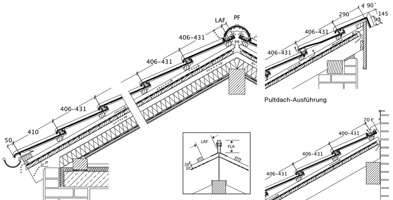
Dachquerschnitt Entlüftung über FALZ. Firstziegel trocken verlegt. LQ bis ca. 230 cm<sup>2</sup>/l/m First. Trauflattenabstand variabel.
