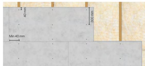
**Kantenabstände bei Standardverbindungen**
