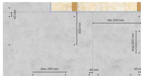
**Kantenabstände an den äußeren Ecken**
