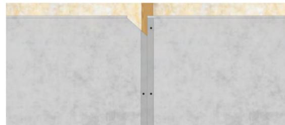
**Geschnittene Plattenstöße müssen abgeklebt werden**
