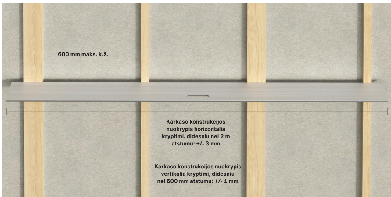
Karkaso konstrukcijos nuokrypiai
