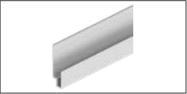
„Swisspearl Plank Connect“ lango profilis Ekstruduotas aliuminis Storis 1,1 mm Ilgis 3000 mm
