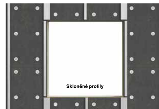
Pohled zepředu: Hliníkové nosné systémy v okenních otvorech
