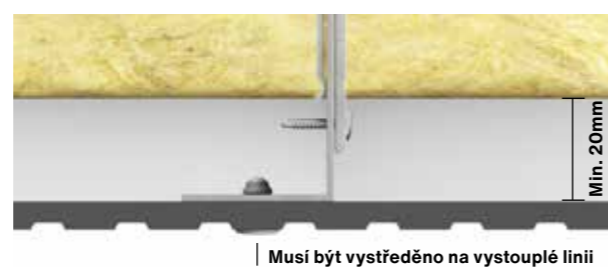
Obr. 2 Instalace panelů Swisspearl Patina Inline na L-profil.
