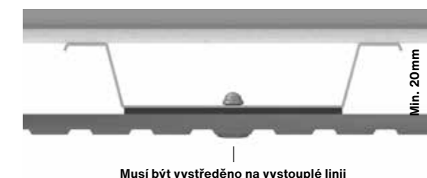
Obr. 2. Instalace panelů Swisspearl Patina Inline na středový profil.
