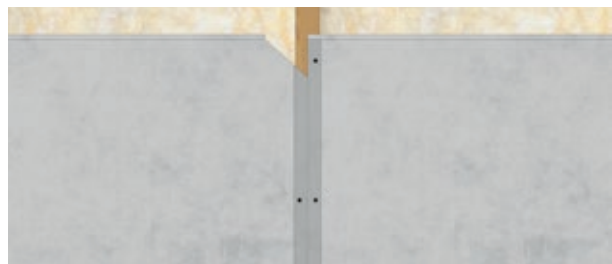
Voegen van afgezaagde panelen moeten worden afgeplakt
