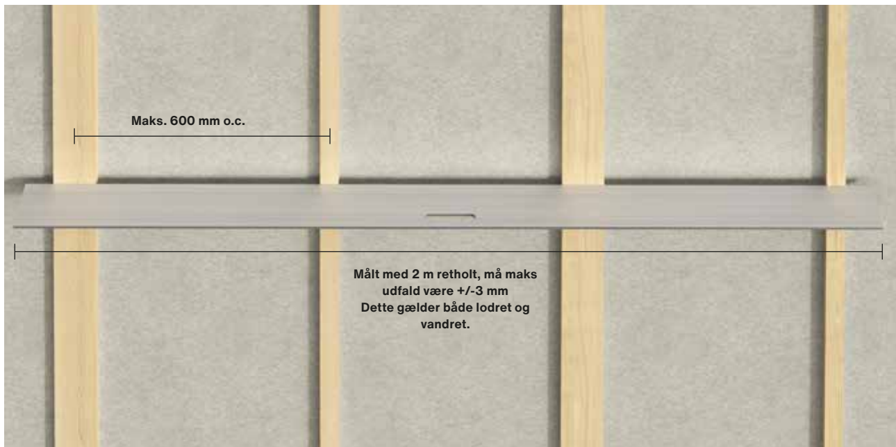
Tolerancer i underkonstruktionen
