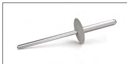
Rivets aluminium Swisspearl Rondelle EPDM RIV-A 4,0 x 20 mm Corps en aluminium et tige en acier inoxydable. Panneaux de façade non peints ou peints Plage de serrage 11-15 mm
