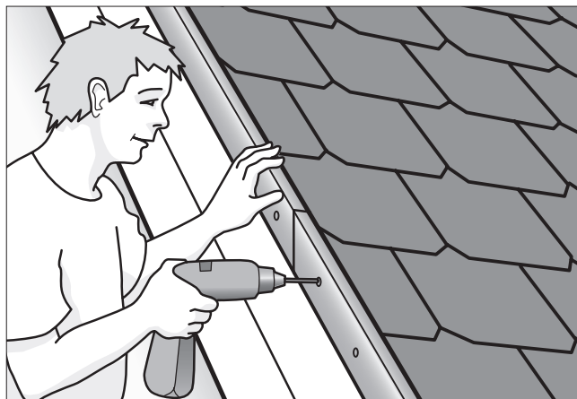
Fastgør løse inddækninger.
